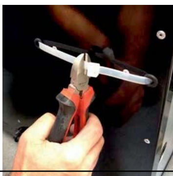
Obr. 2: Přeřízněte pásku vhodným nástrojem.
