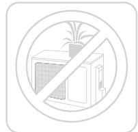
Zkontrolujte, zda nic neblokuje všechny přívody a odvody vzduchu.
