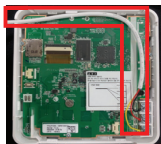
Reference. tvar ohnutého kabelu
