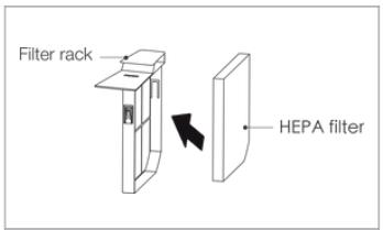
3. Vyjměte filtr HEPA a držák filtru z klimatizace a vložte nový filtr HEPA.
