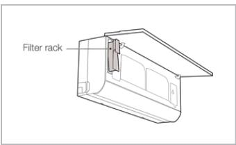
4. Před zapnutím znova vložte filtr a znova umístěte panel.
