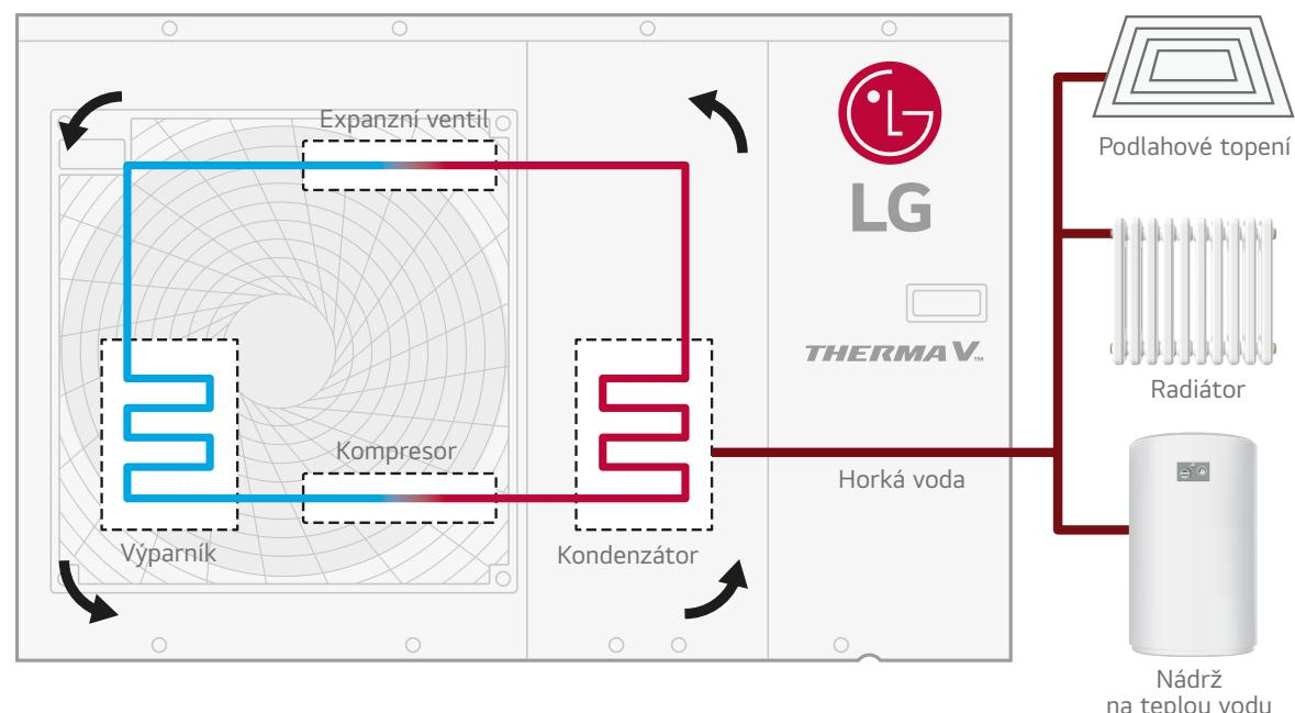
Ve výparníku tepelného čerpadla je teplo odebíráno chladivem, které se vypařuje již při velmi nízkých teplotách. Jeho páry jsou následně stlačeny kompresorem, čímž dojde k jejich ohřátí. Ohřáté chladivo předá v kondenzátoru teplo do topné vody, zchladne a změní své skupenství na kapalné. Celý cyklus se pak opakuje.
